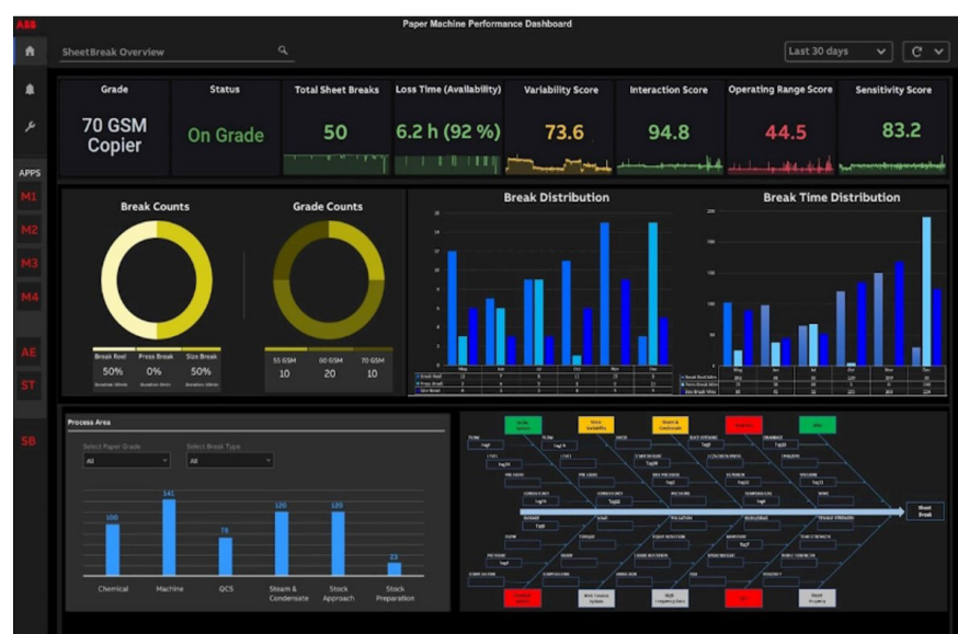
Hình 1. Giao diện vận hành hệ thống giám sát đứt giấy
