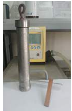
1- Vòng treo, 2-Rãnh giảm áp, 3-Nắp xoáy, 4-12 ren trên inch NF hoặc tương đương, 5-Nắp khum bên trong để bảo vệ vòng đệm "O" khi đóng bình áp suất, 6-Vòng đệm "O" bằng cao su tổng hợp không có lưu huỳnh, 7-Ống đúc bằng thép không gỉ, kết cấu hàn, Áp suất đồng hồ thử lớn nhất: 700 kPa.
